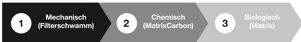
Abb. 5: Schichten der Filtrationsmodule (von unten nach oben)
